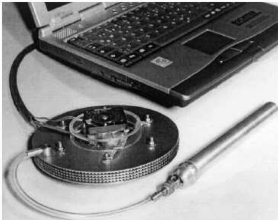
Fig. 4.10 Un stack conformado de 4 celdas de combustible y una potencia máxima de 55 W conectada a un convertidor de corriente directa para liberar una diferencia de potencial de 1.5 - 3.5 V. [21]
