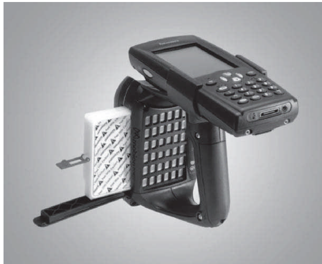
Fig. 4.7 Celda de combustible con un cartucho de metanol en un teléfono celular. [19]
