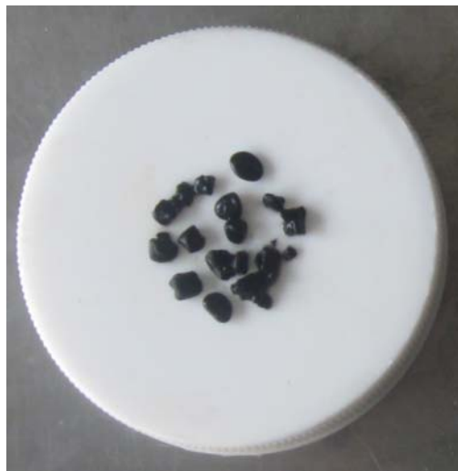
Figura 4.1. Gránulos anaerobios para la inoculación del reactor UASB
