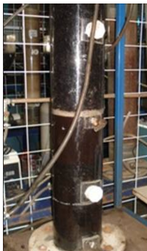
Figura 4.25. Fenómeno de acumulación de biogás en el reactor UASB
