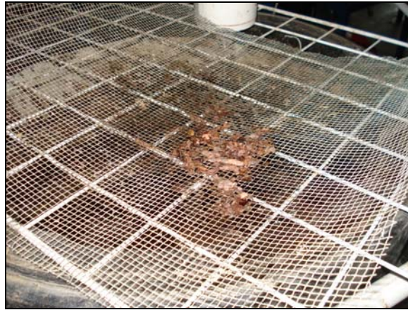
Figura 3.3. Fotografía de sólidos retenidos del agua de rastro cargada al tanque de alimentación
