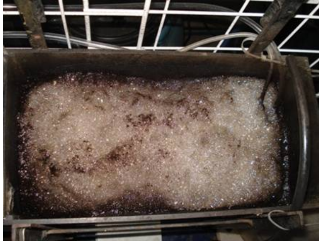
Figura 4.50. Formación excesiva de espuma en el reactor LA UASB
