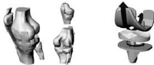
Figura 2.4.3. Reconstrucción del volumen del hueso y modelo en 3D de la prótesis. [15]
