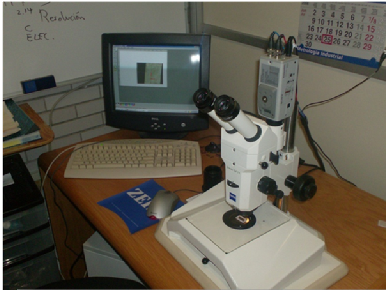
Figura 15. Microscopio estereoscópico Zeiss Stemi SV11 adaptado a una cámara digital.
