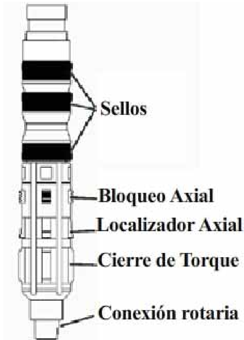
Figura VII.3. Ensamble seguro de perforación. (Gupta, et al, 2007)
