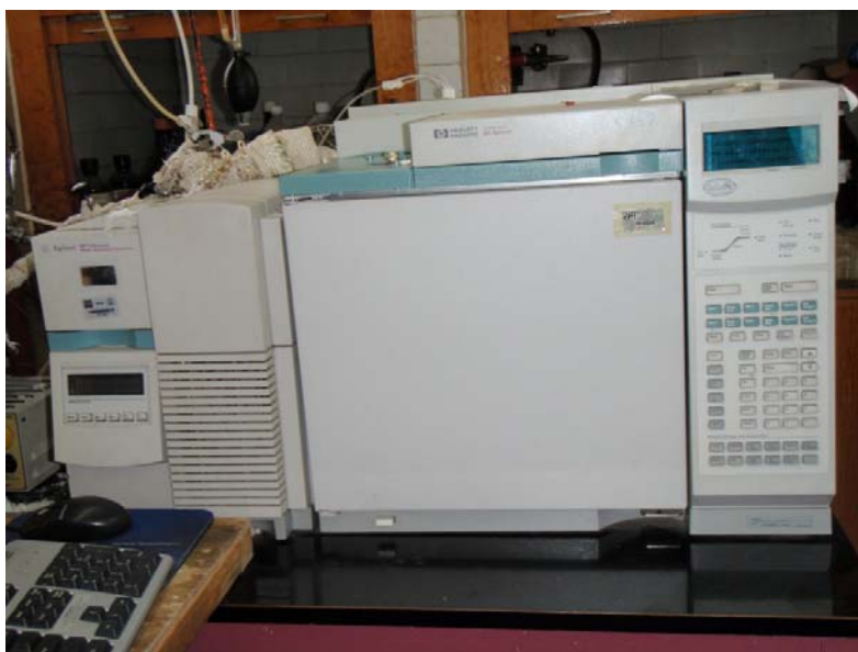
Figura 3.2.2.1 Cromatógrafo de gases modelo HP 6890.
