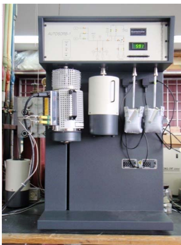
Figura 3.3.1 Equipo Autosorb-1C de Quantachrome.
