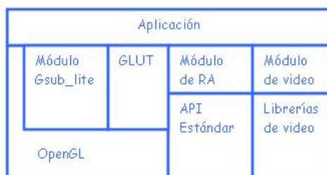
Figura 1.26: Estructura jerárquica de ARToolkit usando el módulo Gsub Lite
