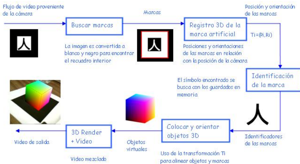
Figura 1.24: Funcionamiento del proceso de incorporar un objeto virtual en una escena real a través de patrones con ARToolkit
