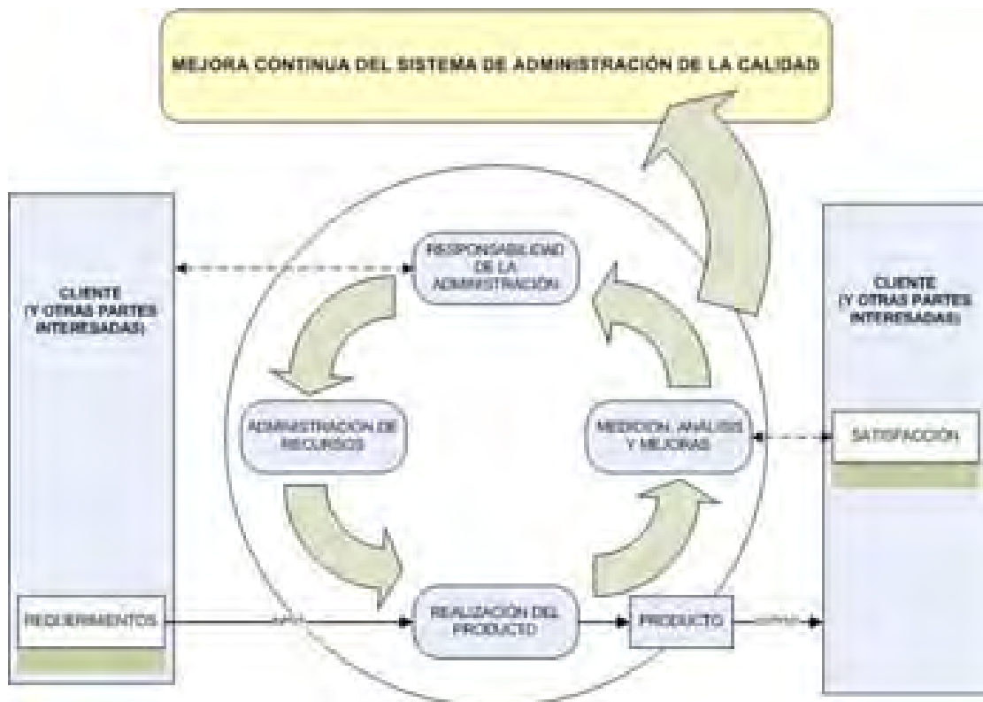
ILUSTRACIÓN 8: MODELO DEL PROCESO BÁSICO DEL SISTEMA DE ADMINISTRACIÓN DE LA CALIDAD (ISO 9000)
