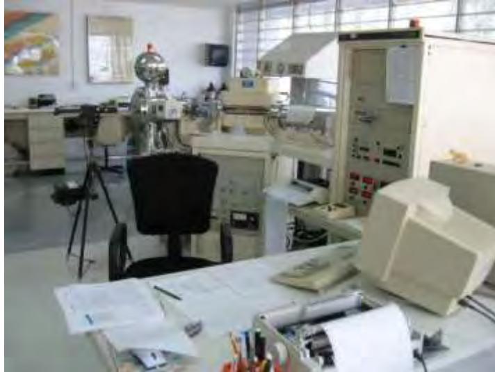
Foto 37. Espectrómetro de masas FINNIGAN MAT 262 . LUGIS-UNAM.
