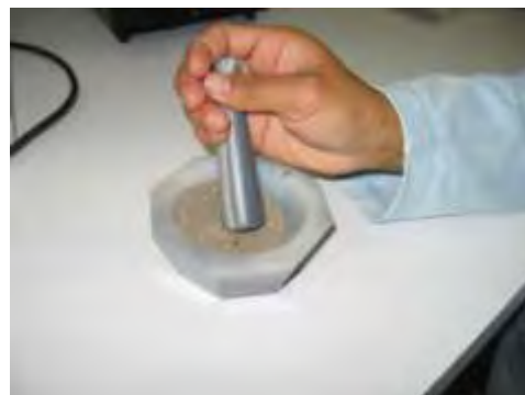
Fotos 31-32. Mortero de ágata para la pulverizar las muestras de dientes, huesos y suelos.
