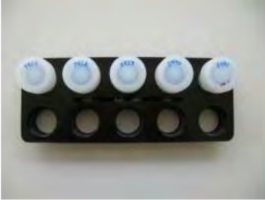
Fotos 35-36. Izquierda: muestras listas para pesarse dentro de sus bombas de teflón. Derecha: balanza analítica de cinco dígitos OHAUS del LUGIS.
