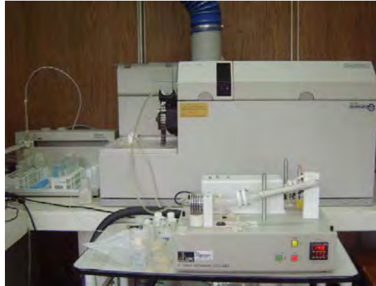
Figura 32. Nebulizador ultrasónico (USN) U5000AT acoplado a ICP-MS
