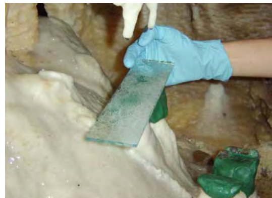
Figura 27. Colecta de calcita secundaria en vidrio horizontal
