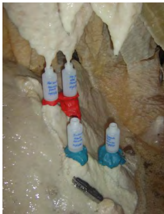
Figura 20. Colecta de agua de filtración en zona de muestreo
