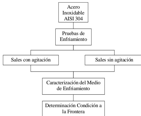
Figura 4.1: Diagrama de flujo del procedimiento experimental para la caracterización del medio de enfriamiento y la determinación de la condición de frontera.
