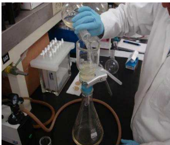
Figura 2.21 Filtrado de las muestras de agua de la planta de tratamiento de aguas residuales en C.U.
