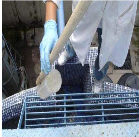
Figura 2.18 Toma de muestras del Sistema Rociador del sedimentador de la planta de tratamiento de aguas residuales en C.U.
