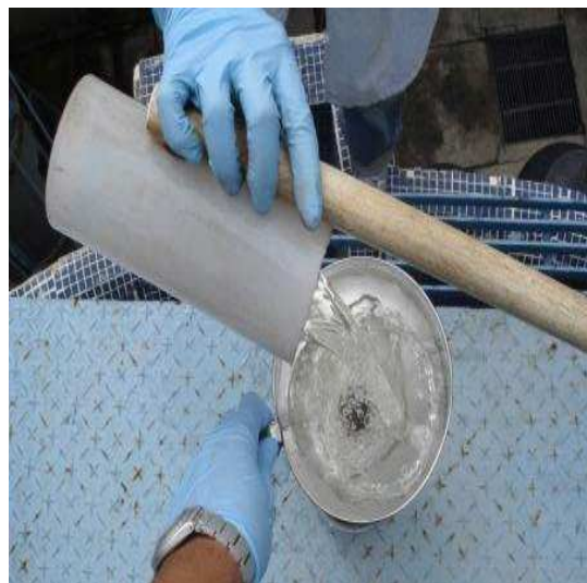
Figura 2.20 Toma de muestras del Sistema Biodiscos del sedimentador de la planta de tratamiento de aguas residuales en C.U.
