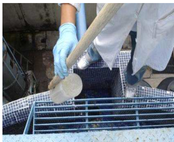
Figura 2.16 Toma de muestras del sistema de lodos activados del sedimentador de la planta de tratamiento de aguas residuales en C.U.
