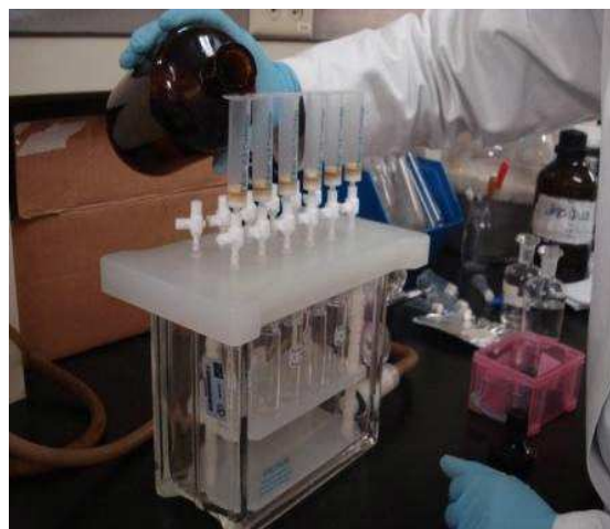
Figura 2.22 Acondicionamiento previo con acetona de cartuchos oasis HLB.
