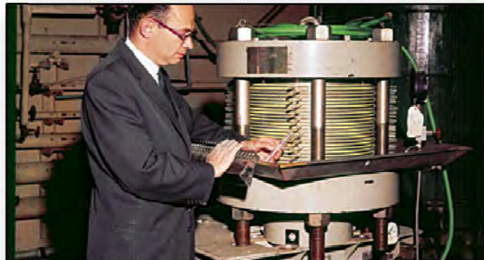
Figura 1.2. Sidney Loeb trabajando con una de las primeras máquinas desaladoras mediante ósmosis inversa. Fuente: http://www.magazine.ucla.edu
