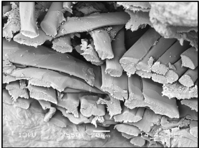
Figura 1.6. Imagen de Microscopía Electrónica de Barrido (MEB) de la estructura de soporte de una membrana anisotrópica. [Tomada en el Laboratorio de Microscopía Electrónica del CENICA]
