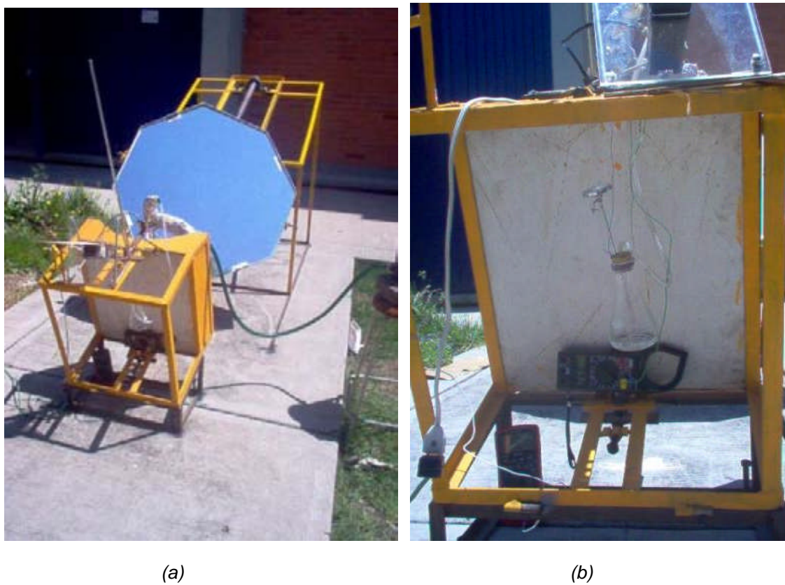
Figura 7.5. La imagen de la fotografía (a) muestra el destilador durante el experimento, en la imagen (b) podemos apreciar la parte trasera del concentrador un matraz conteniendo una pequeña muestra de agua.
