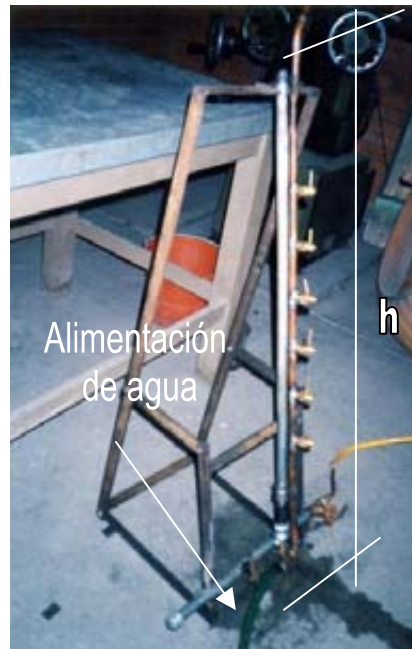
Figura 2.3 Cámara focal y su montaje. El agua se alimenta por la parte inferior, mediante la diferencia de presiones. Esta cámara focal utiliza un quemador de gas.
