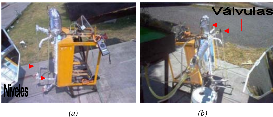
Figura 7.29. Las imágenes de las fotografías muestran el destilador expuesto a la radiación solar, en la imagen (a) se puede apreciar el señalamiento de los tubos de nivel, en la imagen (b) se indican las válvulas que regulan dichos tubos.
