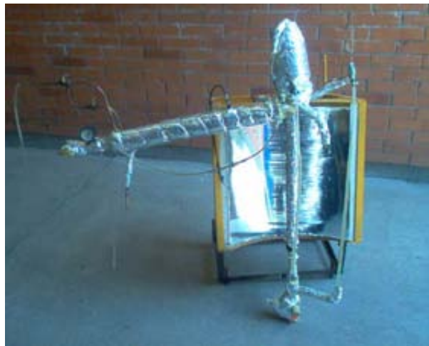
Figura 2.15. La imagen de la fotografía a muestra el montaje del modelo cuatro de la cámara focal en el concentrador.
