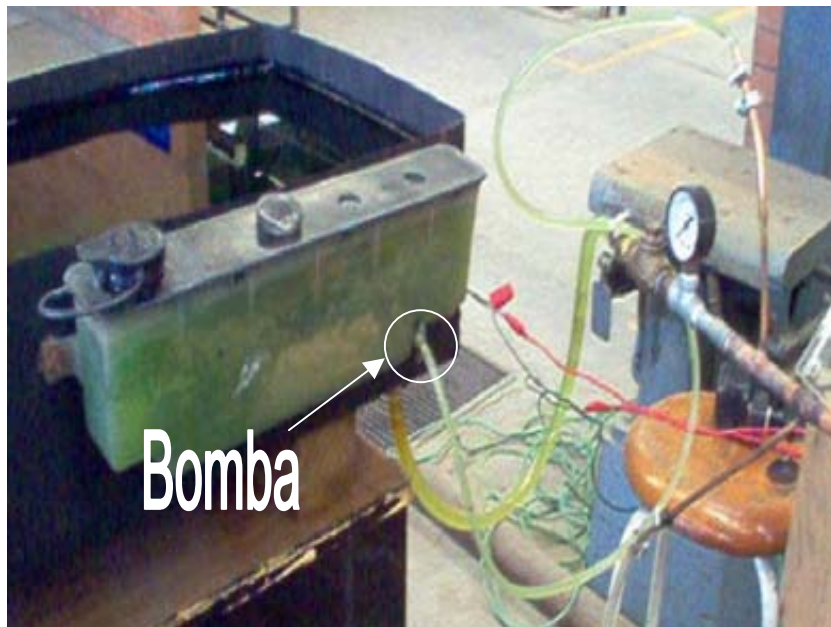
Figura 7.24. La imagen de la fotografía muestra el depósito que alimenta la bomba, misma que señalamos en el interior de la circunferencia.
