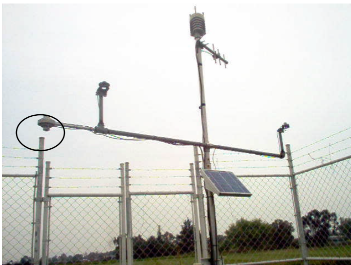
Figura 5.3. La fotografía nos muestra la imagen de la estación meteorológica automática Almaraz de lado izquierdo suspendido de una barra el pirheliómetro tipo Kipp & Zonen dentro de una circunferencia monitorea la radiación solar.
