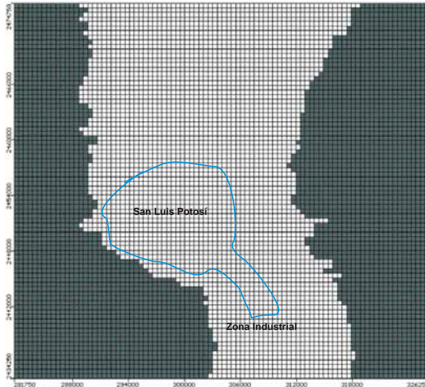
Figura 3.4 Mallado del área modelada. La línea azul es el contorno de la ciudad de SLP y al sureste la zona industrial.
