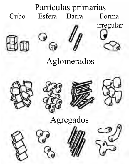
Figura 2.1: Partículas primarias, aglomerados y agregados
