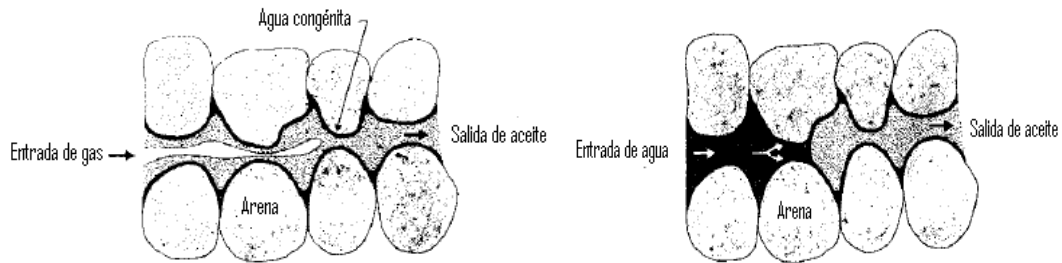
Figura I.6. Comparación entre los desplazamiento por gas (izquierda) y agua (derecha). 3
