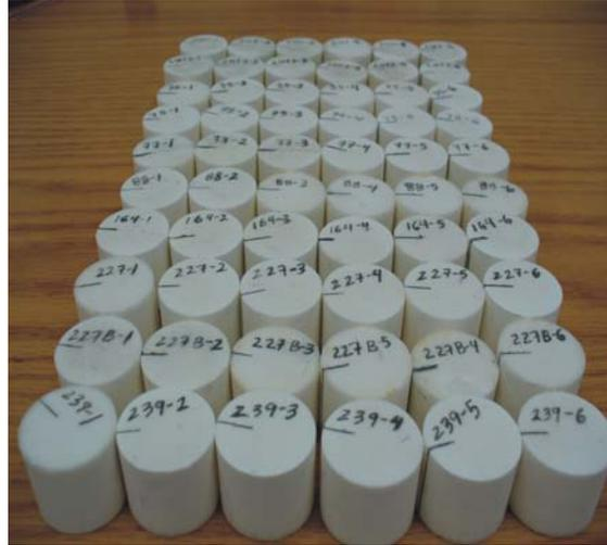
**Figura 54.** Muestras de cerámica encapsuladas en pastillas de sal de tamaño paleomagnético estándar.
