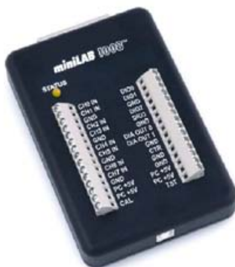
Fig. 2. MiniLAB 1008 Tarjeta de envío y adquisición de datos.
