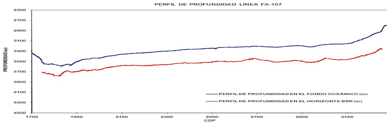
Figura 25. Conversión de los reflectores de tiempo a profundidad de la línea FA-107. En azul, el perfil del piso oceánico, en rojo, el horizonte BSR.
