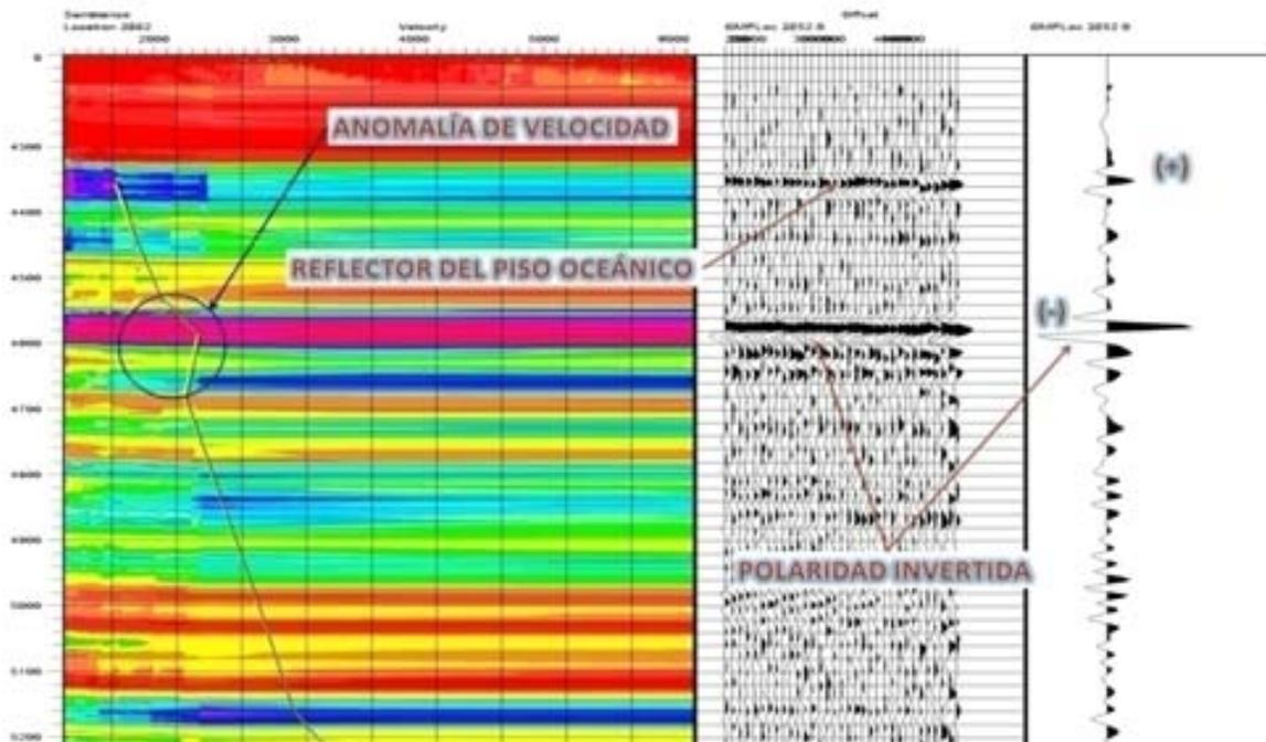
Figura 33. Panel de semblanza para corrección por NMO en SPW para la línea FA-107. A la izquierda, el pico de velocidad. Al centro y derecha un CMP's corregidos por NMO y traza control para identificar la polaridad del piso oceánico y BSR.
