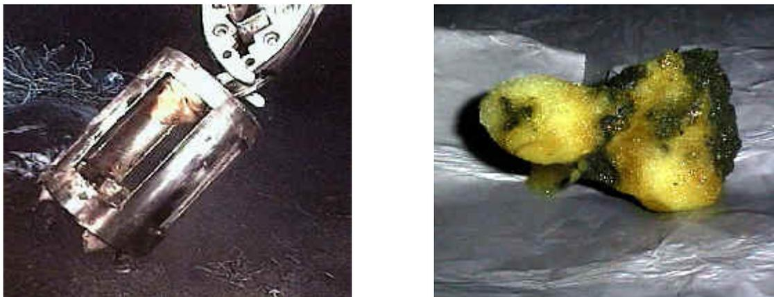
Figura 5. A la izquierda herramienta para toma de muestra del lecho marino, a la derecha, muestra de hidrato de metano obtenida del piso oceánico. Fuente: IFM-Geomar, pagina web: [http://www.ifm-geomar.de/index.php?id=gh\\_proben&L=1](http://www.ifm-geomar.de/index.php?id=gh_proben&L=1)
