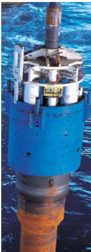
FIG. II.3 sistema típico de cabezales submarinos son los de la configuración de 18 \frac{3}{4} " Propiedad VETCO
