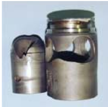
FIG VI.35 Daños causados por la arena
