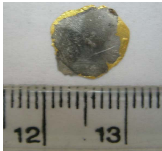
Imagen 25. Unión Au-Pt mediante forja en caliente.
