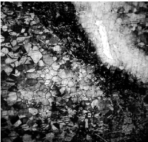
Imagen 10. Homogenización total 88hrs, 500x MEB.
