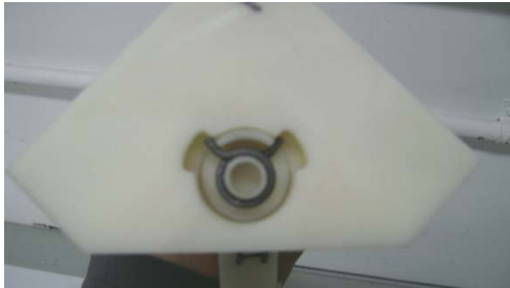
Figura 4.22. Resorte torsional ahorca perno de eslabón.
