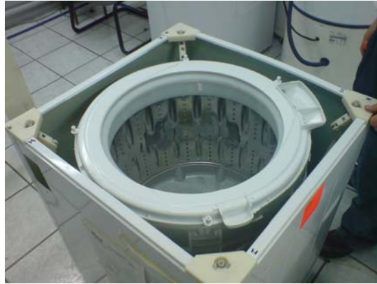
Figura 4.16. Ensamble de suspensión prototipo con sublavadora.
