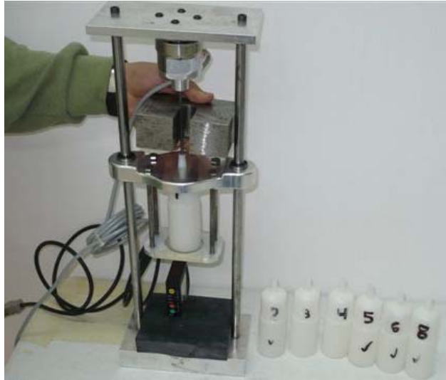
Figura 2.40. Dispositivo de medición de amortiguamiento.
