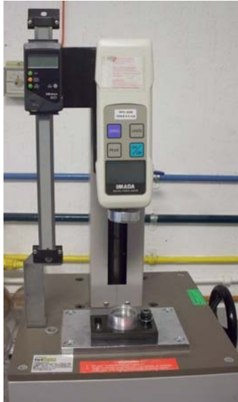
Figura 2.39 Dispositivo para medición de rigidez de resortes lineales.
