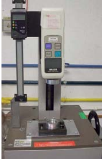
Figura 3.31. Dispositivo de medición de rigidez de resorte.
