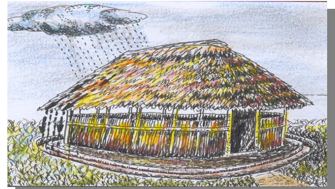
Tomada de: Iliana Herrera, elaborado por el autor, Cubierta muy inclinada para evacuación de aguas lluvias, 2007, Foto (73)
