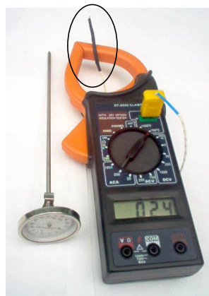
Figura 6.1. La fotografía muestra en su imagen del lado izquierdo un termómetro bimetálico de caratula redonda con un tallo de 8 pulgadas, el lado derecho presenta un multímetro digital con un elemento sensor que se aprecia en la parte superior de la imagen.
