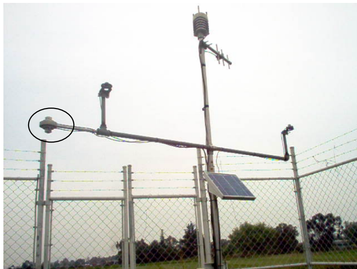
Figura 6.3. La fotografía nos muestra la imagen de la estación meteorológica automática Almaraz de lado izquierdo suspendido de una barra el pirheliómetro tipo Kipp & Zonen dentro de una circunferencia monitorea la radiación solar.
