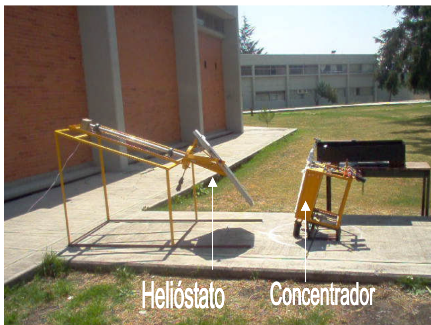
Figura 3.12. La fotografía muestra la imagen del destilador solar. A la izquierda de la imagen el helióstato, frente a él de lado derecho el concentrador parabólico.
