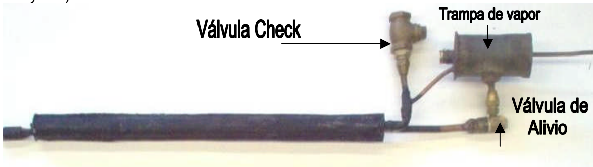
Figura 8.3. La imagen de la fotografía muestra la cámara focal terminada, acoplada a tres elementos, Válvula check, Válvula de alivio y trampa de vapor.
