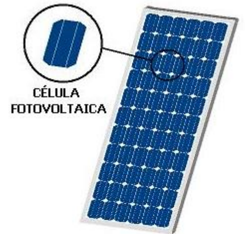
PANEL SOLAR FOTOVOLTAICA
