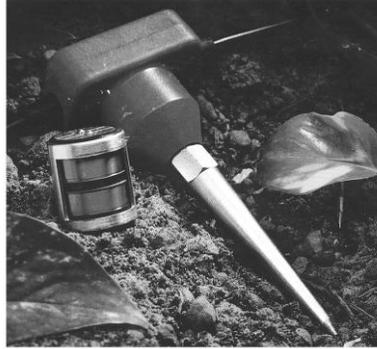
**Figura 2.11 Geófono usado para registrar las ondas reflejadas del subsuelo.**
