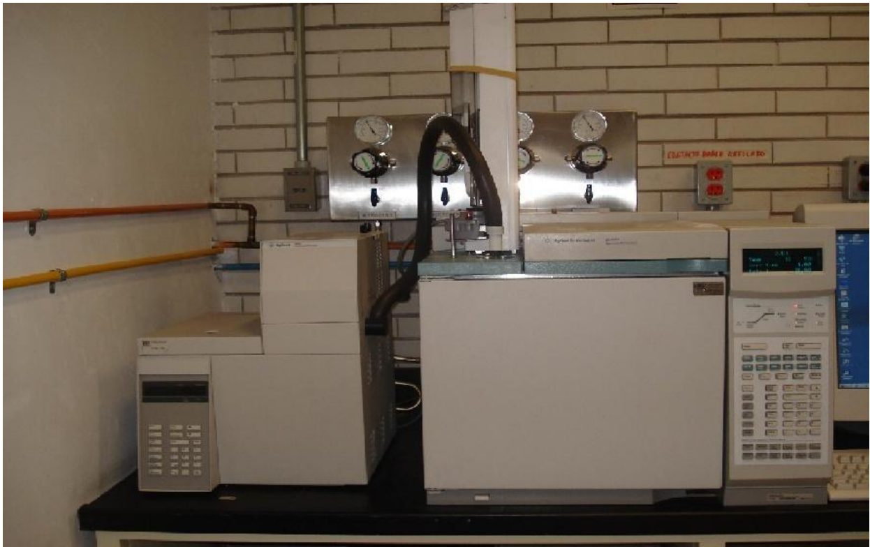
Figura III. 2.- Equipo Headspace Sampler Agilent modelo 7694E, con automuestreador para 12 viales, equipado con una línea de transferencia para acoplamiento a sistema cromatográfico.
