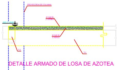
DETALLE ARMADO DE LOSA DE AZOTEA
