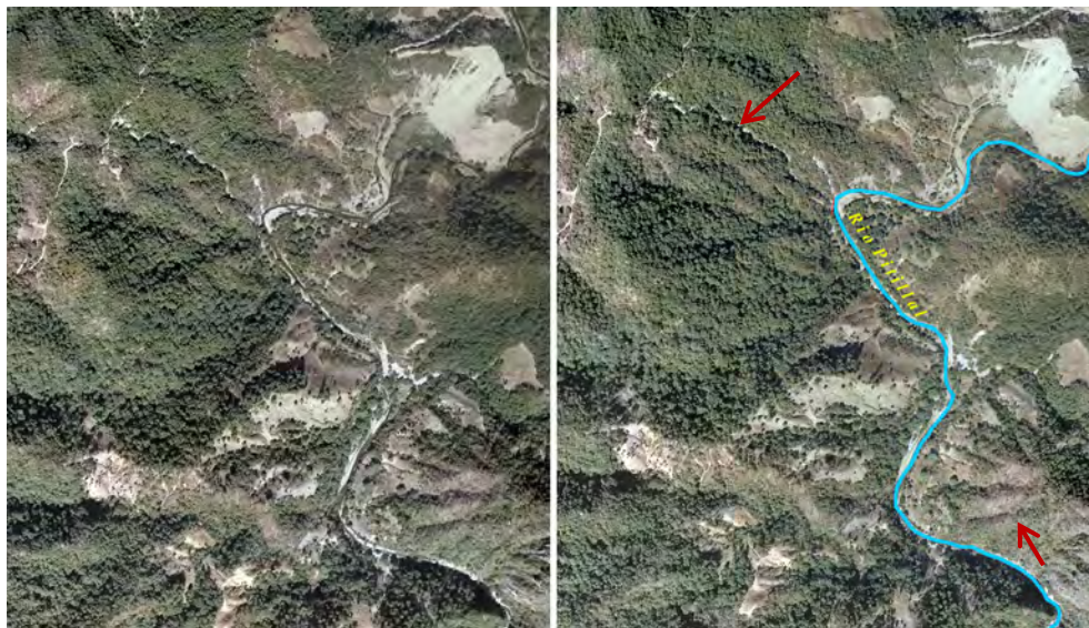
Figura 22. Par estereoscópico de las dos deformaciones gravitacionales profundas (figura 21). Los deslizamientos se señalan con una flecha.
