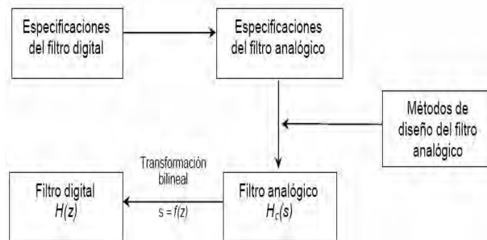
Figura 2.5: Diagrama de bloques del proceso de diseño de un filtro IIR con el uso de la transformación bilineal.
