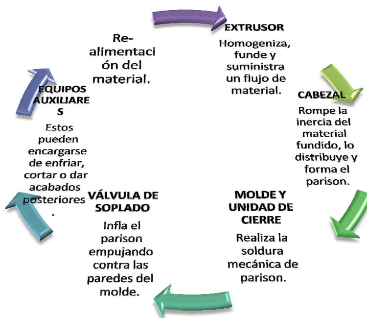
Diagrama 2.2: Etapas de un ciclo de extrusión soplado
