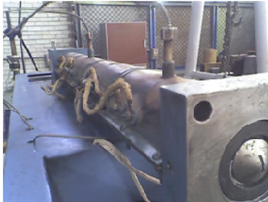
*Imagen 3.24: Condiciones iniciales del Cañón del Extrusor*
