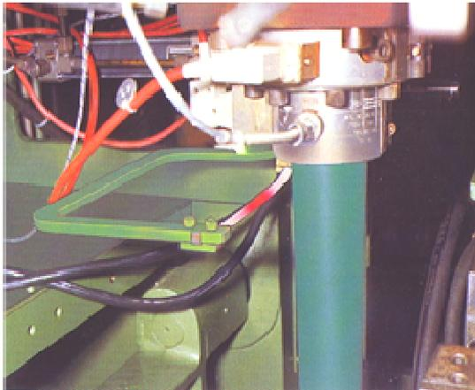
Imagen 2.7: Sistema de corte por cuchillas calientes
