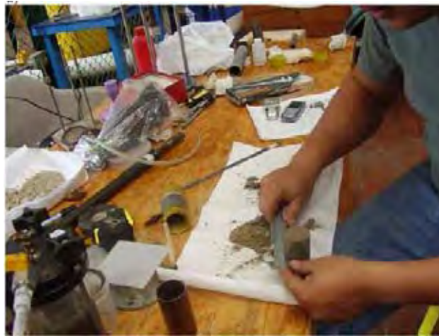
Figura 4.22.- Labrado de muestras.
