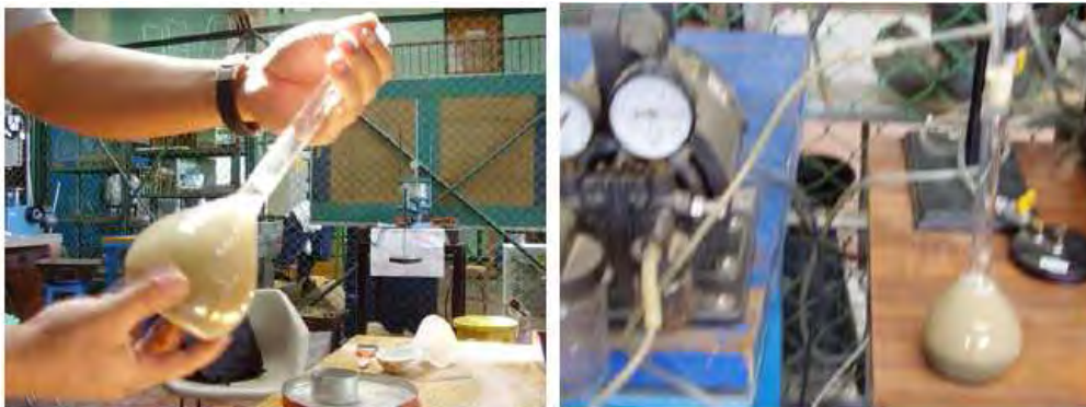
Figura 4.24.- Determinación del peso específico relativo de sólidos S_s .
