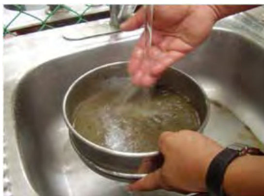
Figura 4.25.- Lavado de suelo malla N° 200.
