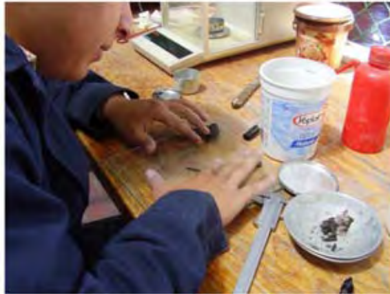
Figura 4.29.-Determinación del límite plástico.
