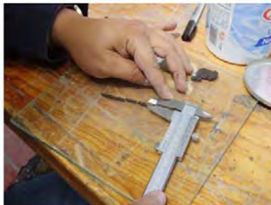
Figura 4.30.-Determinación del límite plástico.
