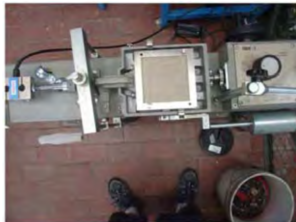
Figura 4.38.- Caja de corte con la muestra de suelo.
