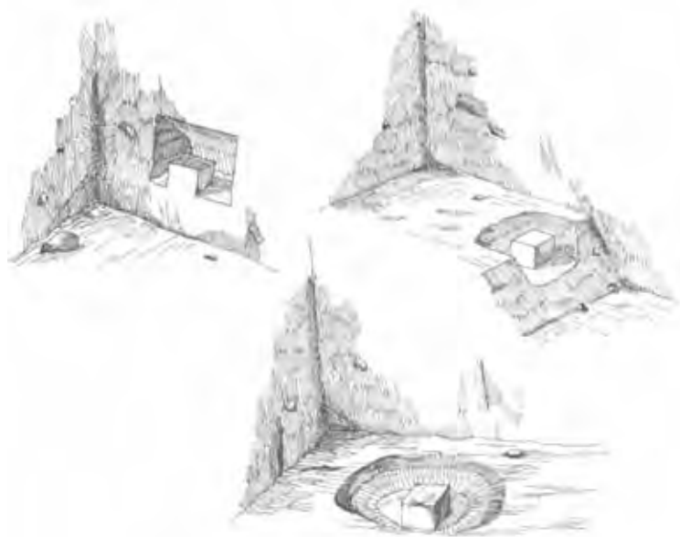
Figura 4.8.- Tallado de muestras en pequeños bloques.
