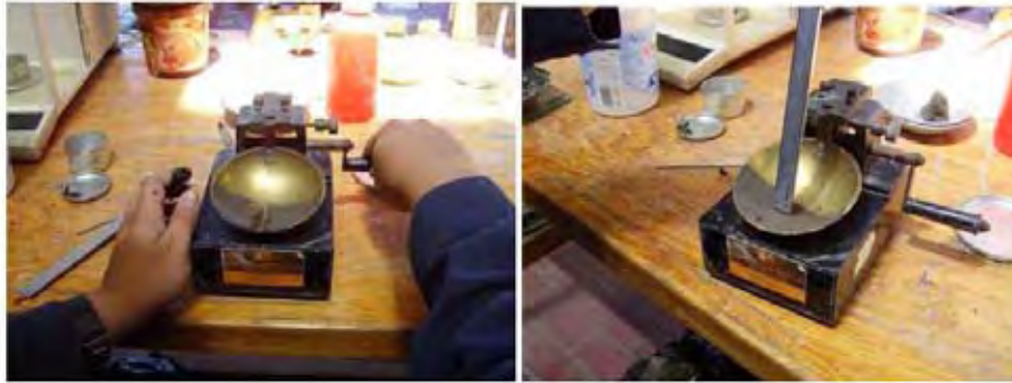
Figura 4.28.-Determinación del límite líquido, mediante la Copa de Casagrande.
