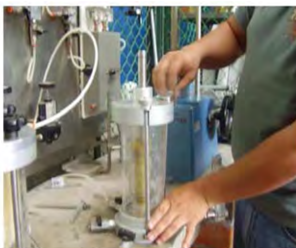
Figura 4.34.- Prueba triaxial rápida, no consolidada no drenada (UU).
