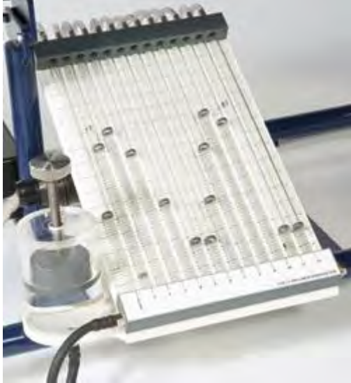
BANCO DE MANÓMETROS INCLINADOS
