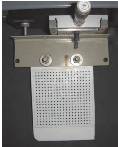
Figura 2.15: Tarjeta de calibración de 100 \times 100 \text{ mm} , formada por un arreglo de puntos negros de 2 \text{ mm} de diámetro, separados una distancia de 5 \text{ mm} uno de otro, sobre un fondo blanco. Contiene un punto central de 2.7 \text{ mm} de diámetro y cuatro puntos marcadores de ejes, con 1.3 \text{ mm} de diámetro.
