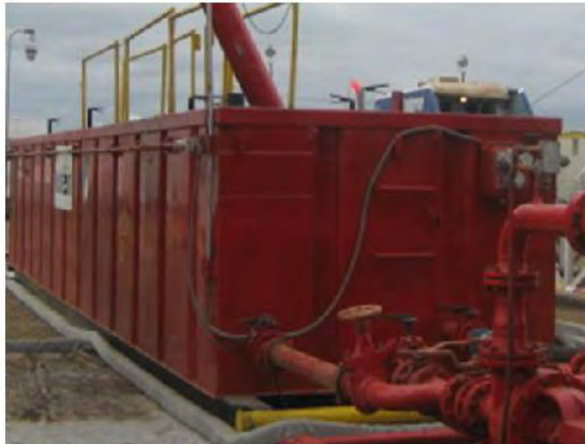
Figura 3.13 Presa de separación Skimmer
