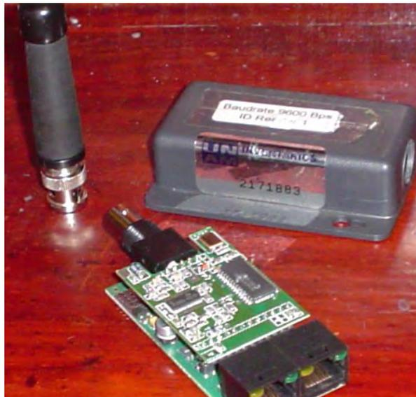
**Figura 3.2 Partes que componen un Lector Wavetrend de izquierda a derecha: antena, circuitería y carcasa.**
