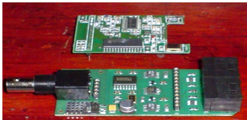
**Figura 3.4 Tabletillas al interior de un Lector Wavetrend.**
