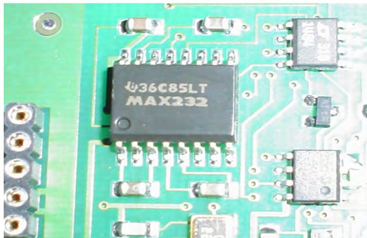
**Figura 2.20 Chip MAX232 para la interfaz con la PC al interior de un Lector Wavetrend.**
