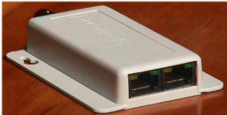
**Figura 3.6 Los puertos RS485 en cada Lector están definidos como puerto izquierdo y puerto derecho. Cortesía Wavetrend Technologies Ltd.**
