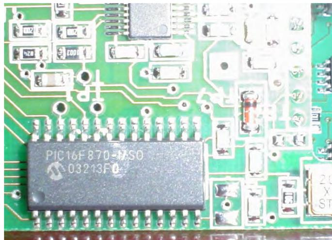
**Figura 2.8 El microcontrolador PIC 16F870 de Microchip al interior de un Lector Wavetrend.**
