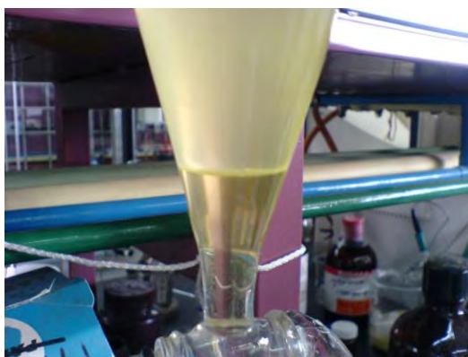
Figura 15. Separación de fases. La fase de arriba contiene el éster y el ácido oleico no reaccionado, la fase de abajo contiene el agua, el metanol sobrante y el ácido sulfúrico.
