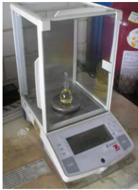
Figura 13. Picnómetro con muestra de aceite siendo pesado en una balanza analítica
