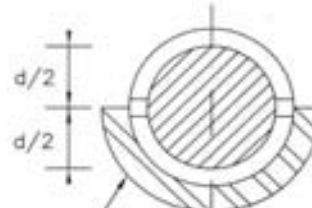
PLACA DE RESPALDO DE 6 mm. DOBLADA EN "MEDIA CAÑA"
