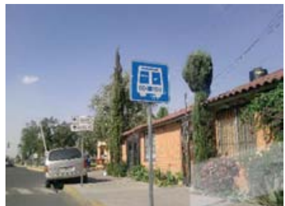
Señalamiento de servicios (película reflejante de color azul y la leyenda ó filete con tinta color blanco)
