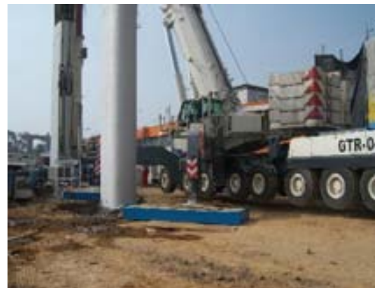
En cada estabilizador se colocaron planchones o placas de transmisión de esfuerzos con la finalidad de tener mayor área de apoyo donde la carga se hace puntual.
