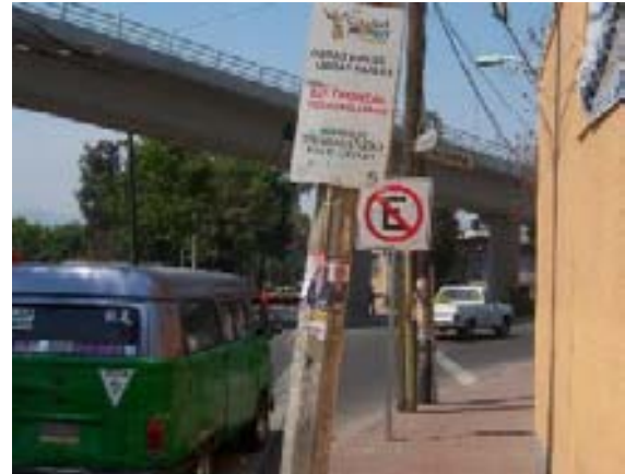
Señalamiento restrictivo (fondo de color blanco con película reflejante de alta intensidad, el anillo será de color rojo el símbolo ó filete serán de color negro)
