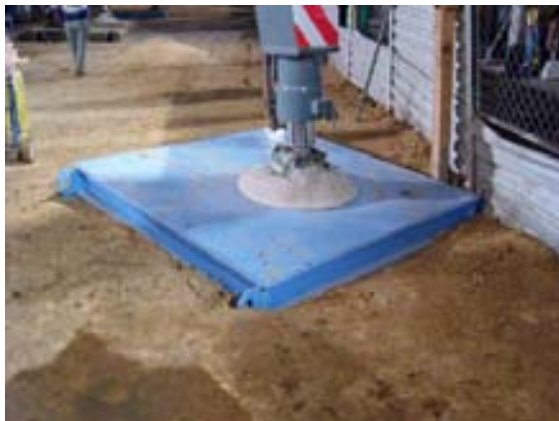
En cada estabilizador se colocaron planchones o placas de transmisión de esfuerzos con la finalidad de tener mayor área de apoyo donde la carga se hace puntual.
