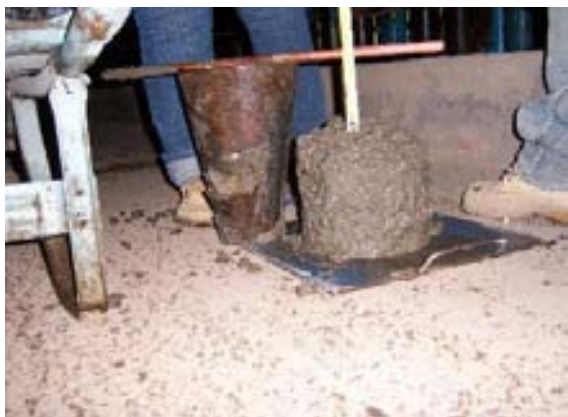
Prueba de revenimiento del concreto.
