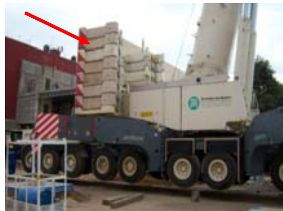
Los contrapesos se colocaban en función del peso del elemento que se iba a levantar
