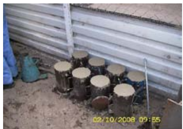
Cilindros para pruebas de compresión
