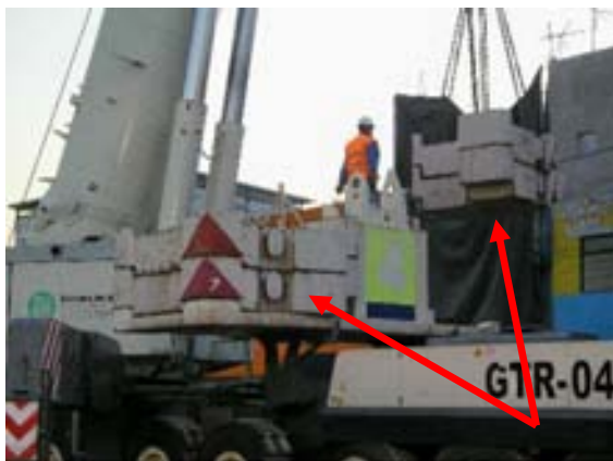
Los contrapesos se colocaban en función del peso del elemento que se iba a levantar
