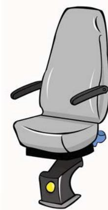
Asiento para conductor, con espumado y tapizado en poliéster, apoya brazos movibles, ajuste de desplazamiento adelante/atrás de 10 cm, inclinación del respaldo de 15 Grados, cinturón de seguridad de tres puntos.
