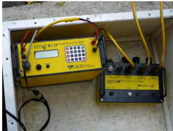
Figura 5.8 Fotografía del equipo utilizado para realizar las TRE 2D y 3D en superficie.
