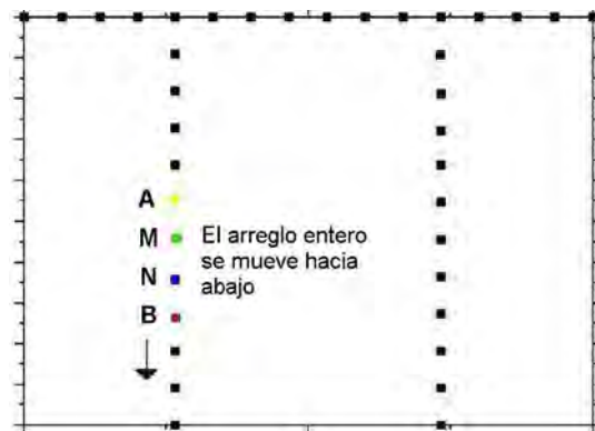
Figura 1.17 Secuencias de mediciones para la configuración del arreglo gradiente.
