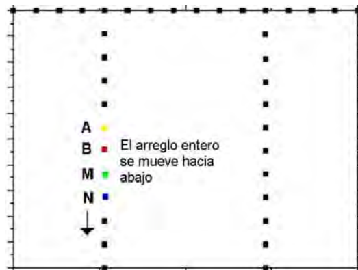
Figura 1.15 Secuencias de mediciones para las diferentes configuraciones del arreglo dipolo-dipolo (AB-MN)
