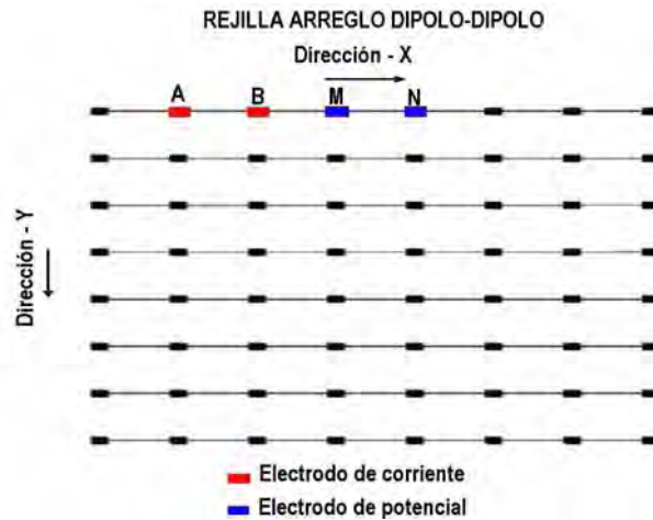
Figura 1.26 Configuración y secuencia de mediciones para el arreglo dipolo-dipolo con líneas paralelas.
