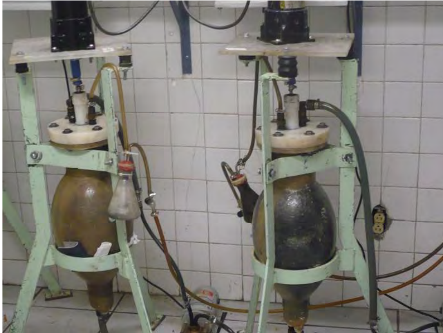
Digestores anaerobios operados durante la experimentación
