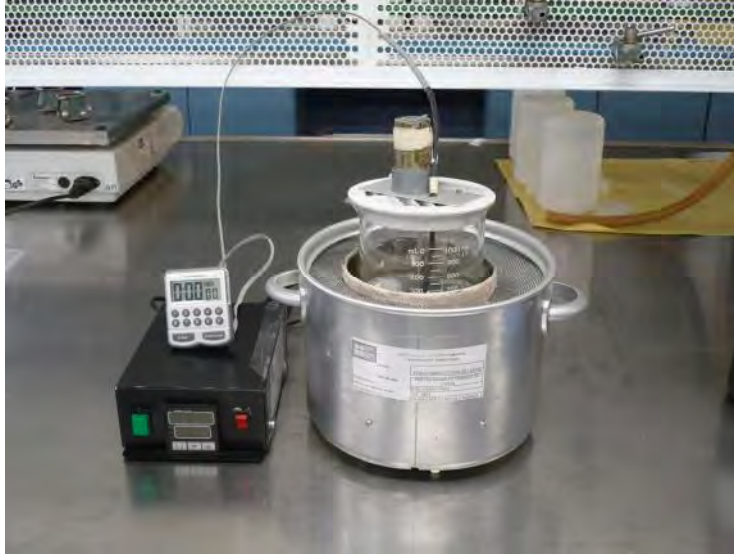
Figura 6.2 Termohidrolizador de lodos utilizado en la experimentación.
