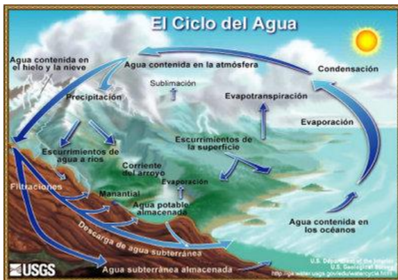
Fig. 01. Esquema del ciclo del agua. Fuente: Departamento del Agua. U.S.
