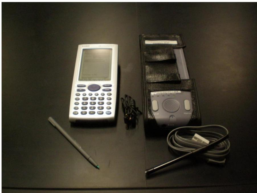
Figura 3. Analizador de datos CASIO (ADC)
