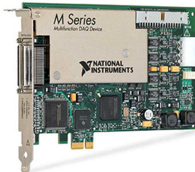
*Figura B.1 Ejemplo de tarjeta DAQ PCI Express*
