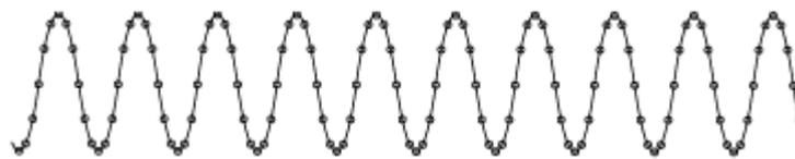
*Figura III.3a Señal adecuadamente muestreada*
