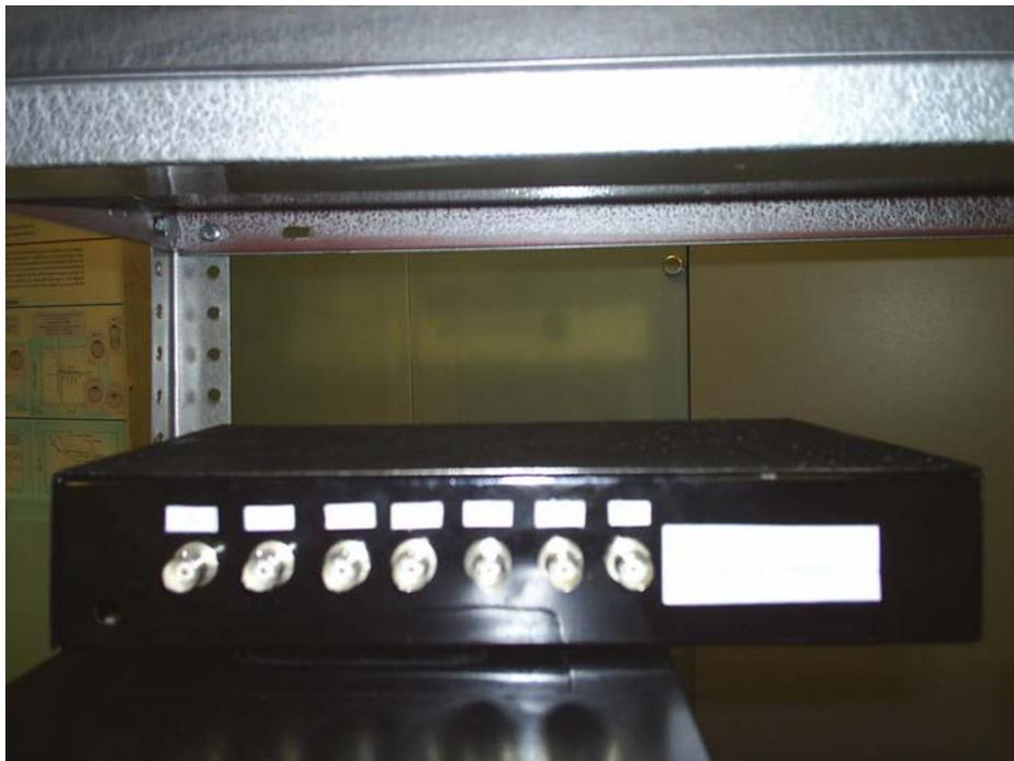
*Figura I.12. Bloque de terminales de conexión*
