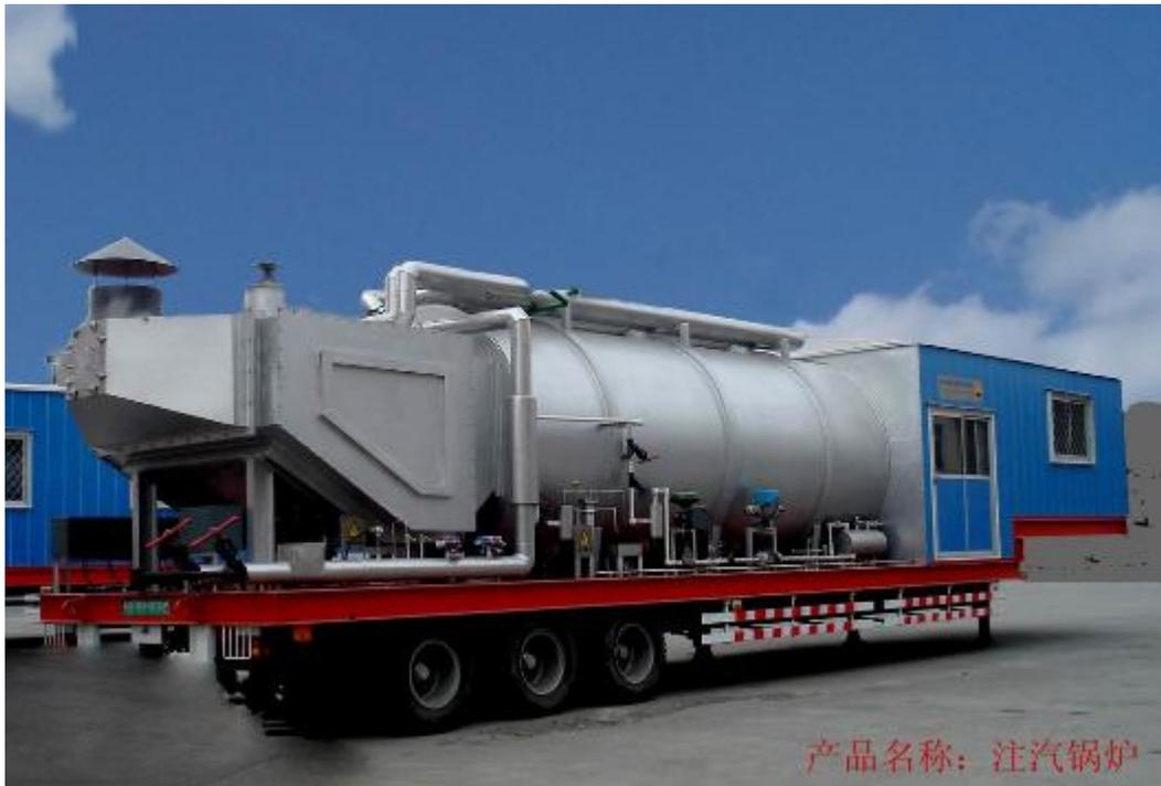
**Figura 7.4** Generador de vapor
