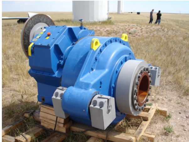
Figura 2.8 Caja de engranes de una turbina eoloeletrica Vestas de 700 kW. Fuente: Propia.
