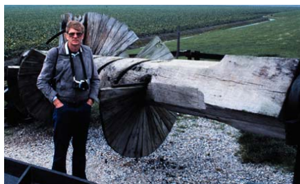
Figura B.2 Ejemplo de una bomba de tornillo construida de madera (Nelson et al, 2004)
