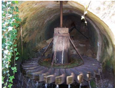
Figura 1. Rueda Hidráulica Horizontal en “La Granja de Esporlas” Mallorca, España. Fuente: Propia
