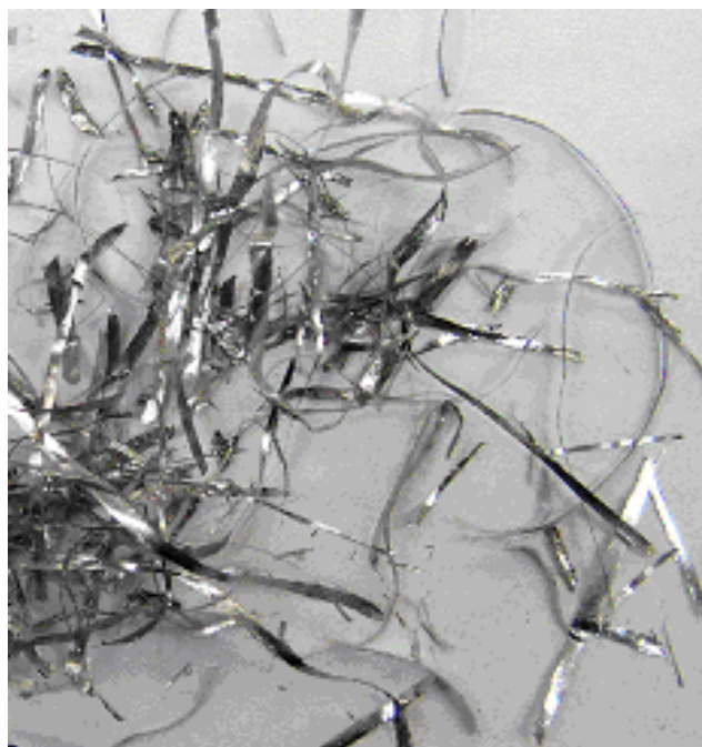
Fig. 4.3 Cintas obtenidas mediante la técnica de solidificación ultrarrápida
