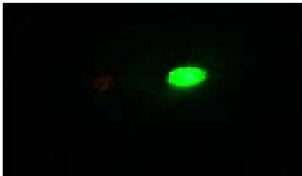
**Figura 5.7.** Transiciones obtenidas con el láser construido en México con una tensión de 14 KV y una presión de 50 mTorr. El color naranja corresponde a  $\lambda = 595.5$  nm y el color verde corresponde a dos transiciones:  $\lambda = 535.2$  nm y  $\lambda = 539.4$  nm
