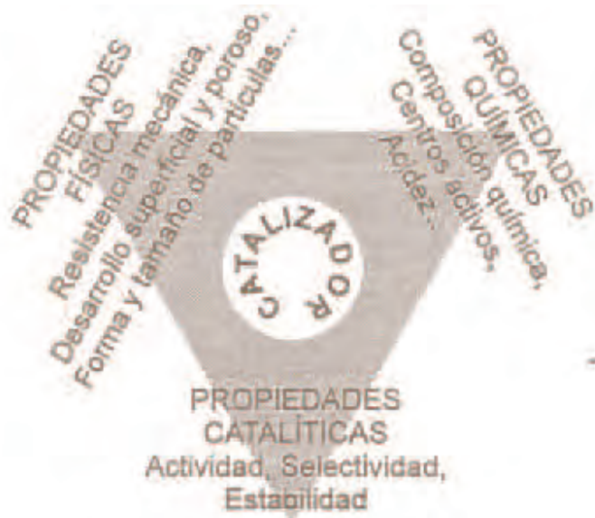
Figura 2-1. Triángulo de diseño de un catalizador sólido [2-1]
